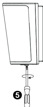
Figuur 8 - Met de schroef vastmaken
